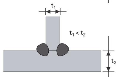
\* Der Zusatzwerkstoff steuert die Arbeitstemperatur, wenn dieser im Vergleich zum Blech ein höheres Kohlenstoffäquivalent hat.
