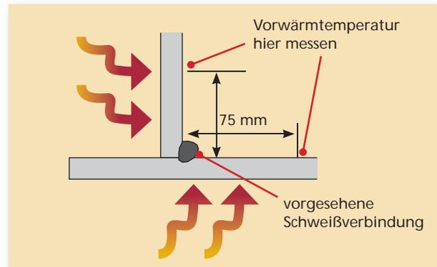
Die Temperatur ist am dickeren Blech des Schweißverbandes zu messen. Die Messung erfolgt bei einem 25 mm starken Blech zwei Minuten nach dem Erwärmen. Ist das Blech 12,5 mm dick, wird die Temperatur nach einer Minute gemessen etc. Die Zwischenlagentemperatur kann am Schweißgut oder am unmittelbar anschließenden Grundwerkstoff gemessen werden.
