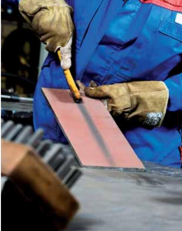
Qualitativ hochwertige Schweißverbindungen erfordern das Entfernen der Primerschicht.
