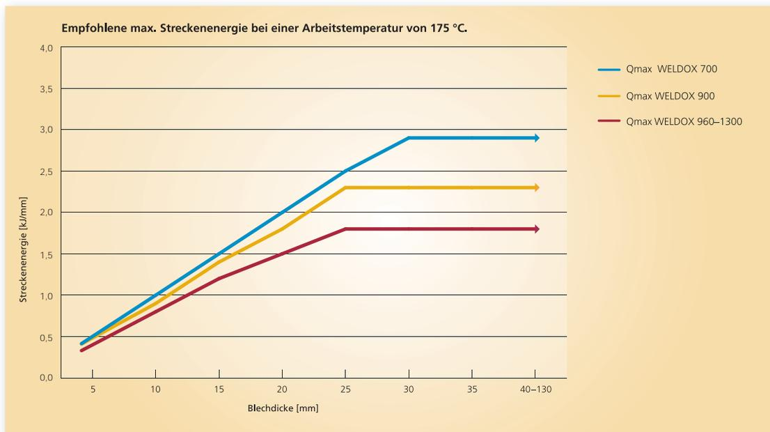
Für Arbeitstemperaturen über 175 °C kann das Softwareprogramm WeldCalc angewandt werden. WeldCalc wurde von einigen der weltweit führenden Experten für Schweißen von Grobblech entwickelt. Es ist kostenlos erhältlich unter [www.ssabox.com](http://www.ssabox.com).
